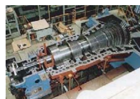
蒸気タービン
